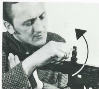
Schusslage rechts - Korrektur nach links
